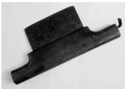
Obr. 1. Nôž garbiarsky. Turiec. Foto M. Fabian, 1993. Fotoarchív SNM v Martine, č. neg. 151407. Evid. č. E-10971.
