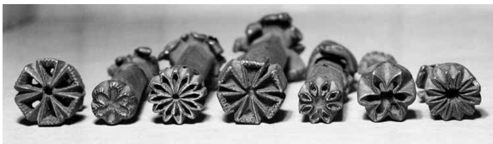
Obr. 26. Razidlá remenárske Š. Muliczkého z Banskej Bystrice. Foto J. Dérer, 1955. Fotoarchív SNM v Martine, č. neg. 023854-002.
